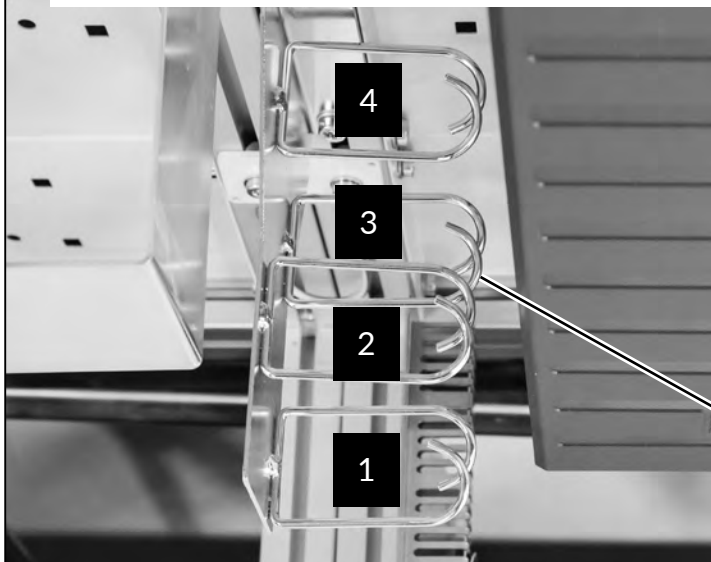
F5 Schutzschlauch ablängen, positionieren Cut protective tube to length, position Découper et positionner la gaine de protection
