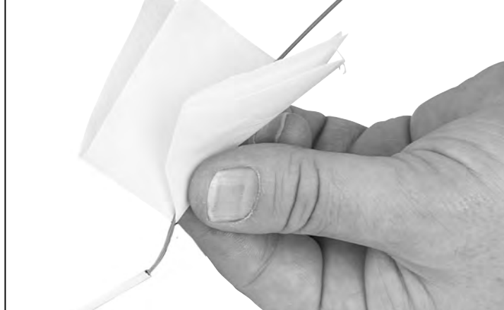
F10 Fasern reinigen mit D-Gel Clean fibers with D gel Nettoyer la fibre avec le gel D
